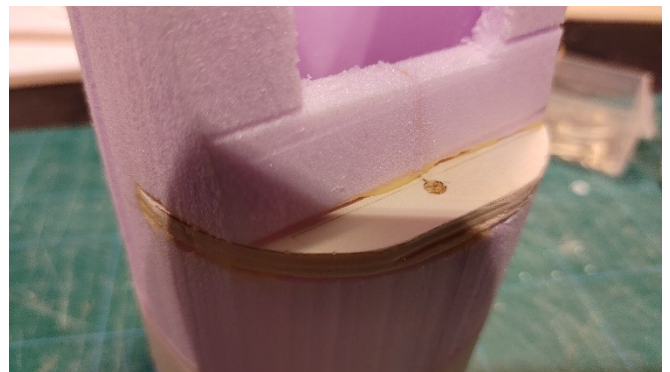
Spantet för vingens fastsättning limmat i kroppen
