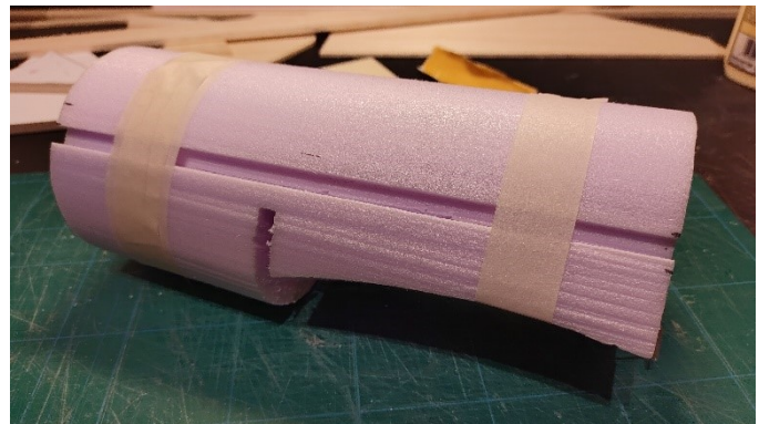
Limning av främre kroppdelen.
