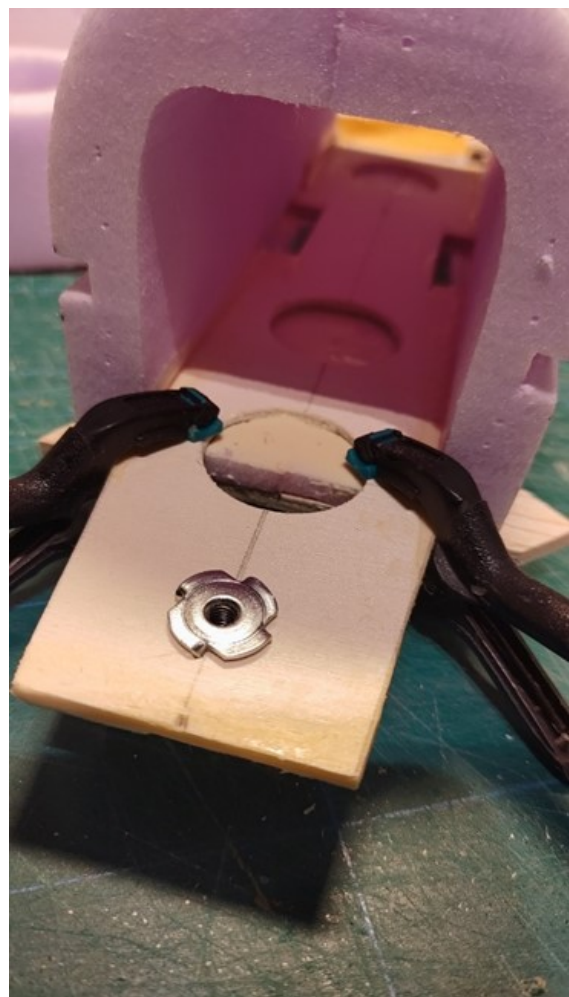
Motorspant med hål och islagsmuttrar för motormontering.
