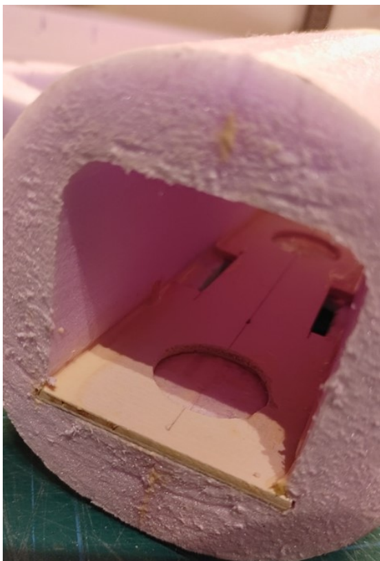
Accplattan ilimmad Limning av motorspant
